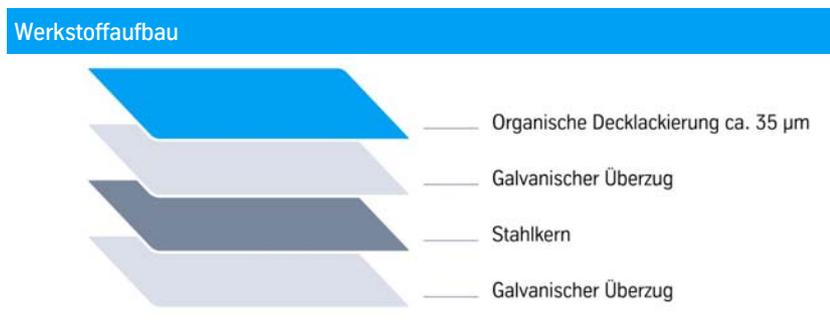
Trägerwerkstoff: Schmelztauchveredeltes Stahlband mit einer Zinkauflage 275 g/m<sup>2</sup>, schmelztauchveredeltes Galfan mit einer Auflage von 255g/m<sup>2</sup> oder einer Zink-Magnesium-Auflage 130–160 g/m<sup>2</sup>
