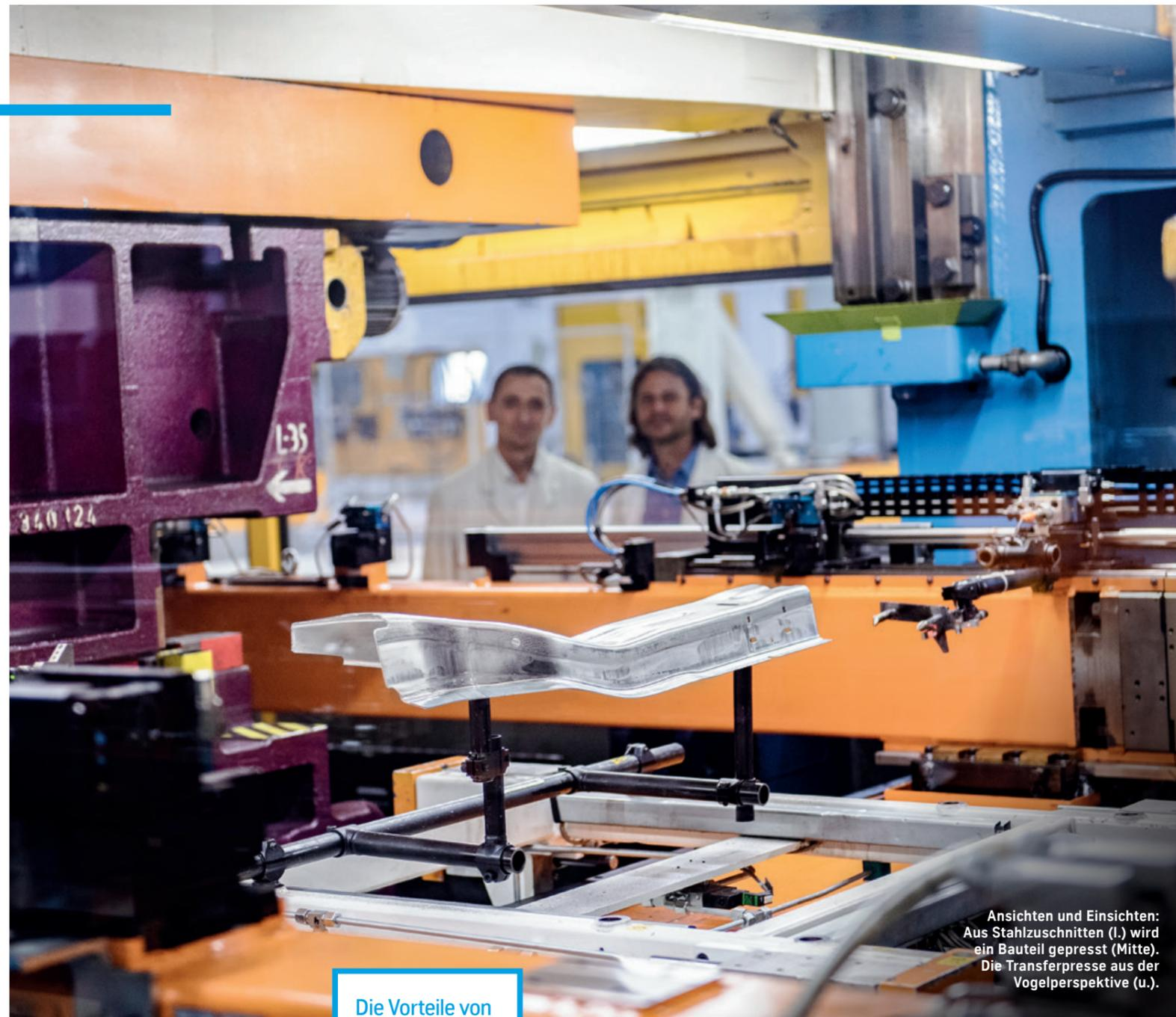
Ansichten und Einsichten: Aus Stahlzuschnitten (l.) wird ein Bauteil gepresst (Mitte). Die Transferpresse aus der Vogelperspektive (u.).
