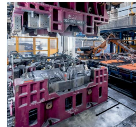
Unter Hochdruck: Die Werkzeuge in Halle 2 pressen mehrere Komponenten pro Minute. Dafür müssen sie regelmäßig überarbeitet werden.
