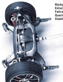
Rückgrat der Konstruktion: Entscheidende Komponenten bei Fahrwerken sind unter anderem Querlenker, Achsträger und Stabilisatoren.
