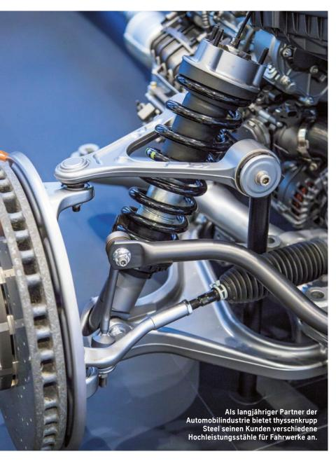
ufgabe des Fahrwerks ist es, dynamische Bewegungen und verschiedenste Kräfte auf die Karosserie zu übertragen. Entscheidende Komponenten bei Fahrwerken sind unter anderem Querlenker, Achsträger
