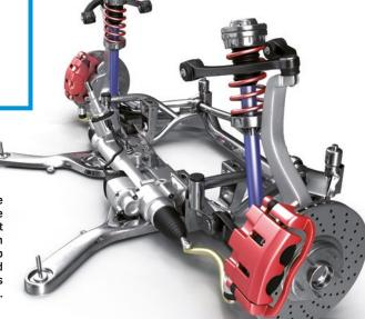
> Blech trotz seiner hohen Festigkeit exzellent lokal umformen lässt. Dass es in dieser seit Jahren bewährten Werkstoffgruppe nicht an Neuentwicklungen fehlt, zeigt der bainitische Stahl CH-W® 660Y760T. Dieser Hochleistungswerkstoff eignet sich optimal für kaltumgeformte Teile mit hohen Anforderungen an die Lochaufweitung beispielsweise beim Querlenker.
