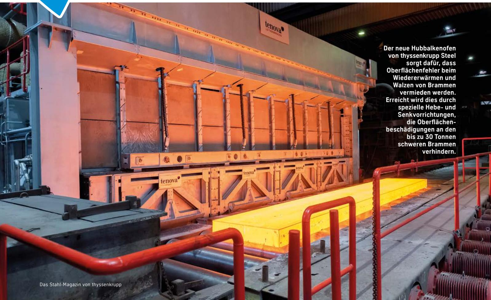
Der neue Hubbalkenofen von thyssenkrupp Steel sorgt dafür, dass Oberflächenfehler beim Wiedererwärmen und Walzen von Brammen vermieden werden. Erreicht wird dies durch spezielle Hebe- und Senkvorrichtungen, die Oberflächenbeschädigungen an den bis zu 30 Tonnen schweren Brammen verhindern.
