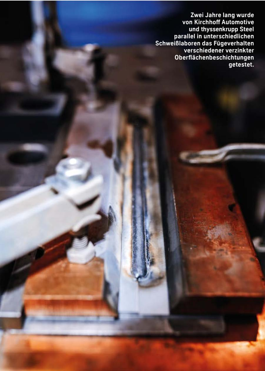
Zwei Jahre lang wurde von Kirchhoff Automotive und thyssenkrupp Steel parallel in unterschiedlichen Schweißlaboren das Fügeverhalten verschiedener verzinkter Oberflächenbeschichtungen getestet.
