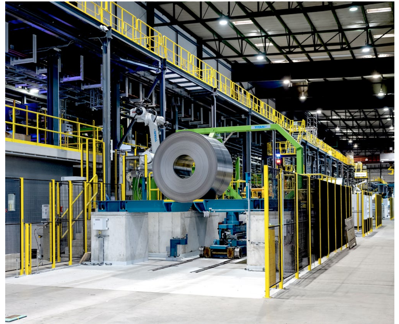
Eines der beiden Kernaggregate im neuen Elektromobilitätskompetenz-Center von thyssenkrupp Steel in Bochum: die neue Glüh- und Isolierlinie (GIL).
