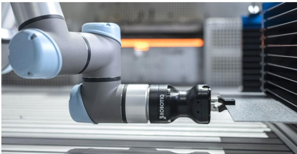
**Die Stahlplatten werden an den Modellanlagen automatisiert gegriffen und in den Ofen gelegt.**
