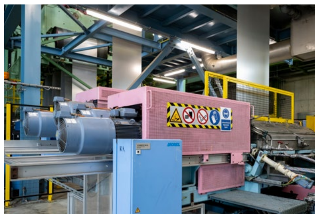
Pink Power: thyssenkrupp Steel hat seine Produktion mit neuen Anlagen fit für die chromfreie Passivierung gemacht und kann somit auch Märkte mit spezifischen Vorgaben bedienen.
