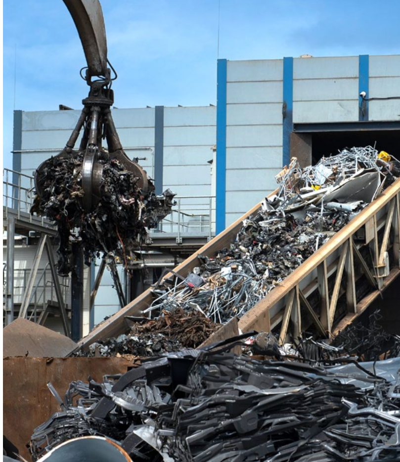
Der Stahlschrott läuft über ein Band in die Anlage, in der aus dem Material mit Hilfe unterschiedlicher Verfahren TSR40 produziert wird.
