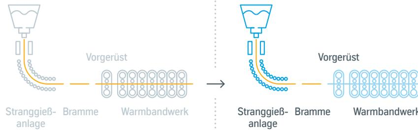
Auftrennung der Gießwalzanlage in eine neue Stranggießanlage 4 (SGA 4) und ein neues Warmbandwerk 4 (WBW 4) in Duisburg zur weiteren Erhöhung der Brammen- und Warmbandqualität und zur Flexibilisierung des Produktionsnetzwerks u. a. wird auch das neue Doppelreversiergerüst in Bochum über diese Linie versorgt.
