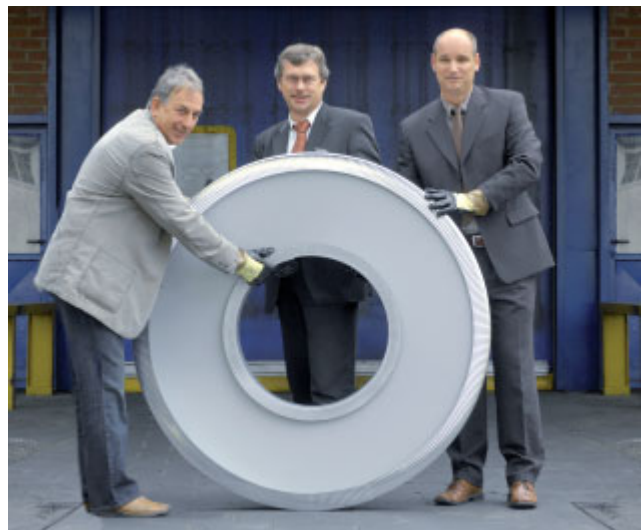
▼ Richtig verpackt, kommt kein Kratzer an das Coil. Neurapack-Kundenberater Jürgen Schroll (links), Matthias Janz (Mitte) und Burghard David (rechts) an einem durch Innen- und Außenwinkel sowie eine seitliche Feinblechrolle vollständig geschützten Coil.
