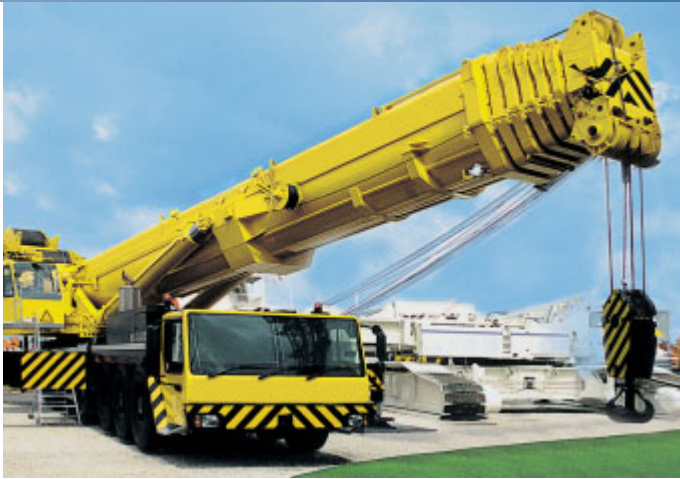
◀ Hohe Nutzlasten bei geringem Eigengewicht: hochfester Stahl der Güte XABO® für den Einsatz im Mobilkranbau.
