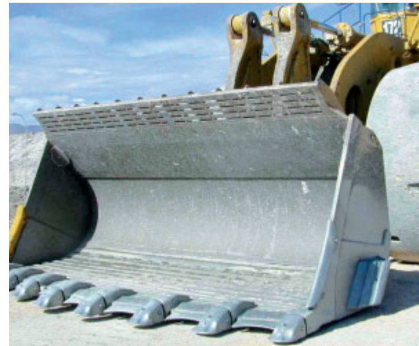
▶ In Baumaschinen kommt verschleißfester Stahl der Güte XAR® zum Einsatz. Dies ermöglicht eine längere Lebensdauer und bringt den Kunden deutliche Kostenvorteile.
