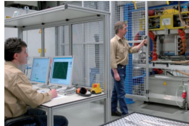
▲ Stefan Majewski (l.) und Volker Becela am neuen Glüh Simulator „Multipas“, der abgesichert in einem Käfig steht. Der Simulator funktioniert nur, wenn die Gittertüren verschlossen sind. Der Raum ist klimatisiert, denn es entwickelt sich bei den Versuchen eine große Hitze.
