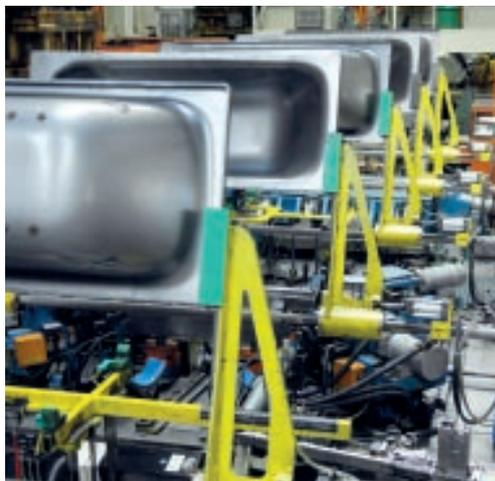
Kaldewei setzt auf hohe Qualität und hat für die Produktion selbst entwickelte Technologien und Verfahrensprozesse. So verfügt das Unternehmen über mehrere Pressstraßen, in denen das Blech in Form gebracht wird.
