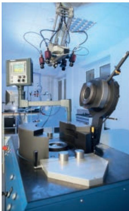
Die neue Universalprüfmaschine ist flüsterleise und wirkt fast zierlich. Denn das große, laute Hydraulik- und Kühlaggregat wurde schallgeschützt außerhalb des Prüfraums untergebracht.
