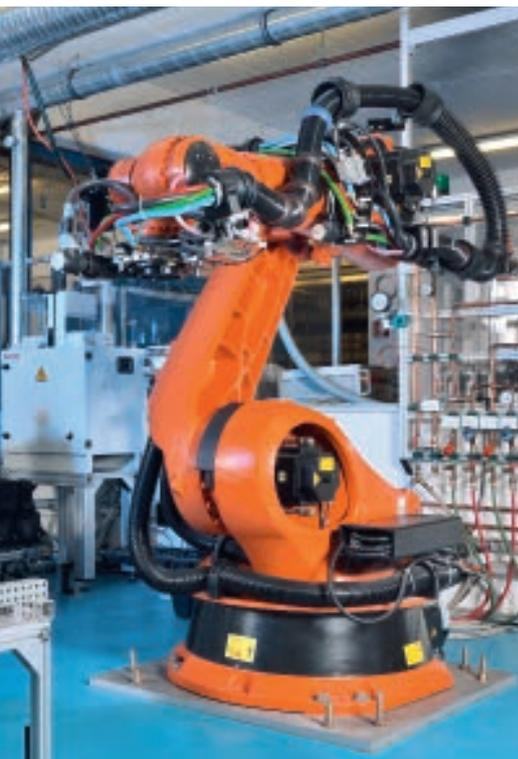
Schweißroboter in der 1.200 Quadratmeter großen Testhalle der Inpro – zum Schweißen von Karosserieteilen aus Stahl von ThyssenKrupp Steel Europe.
