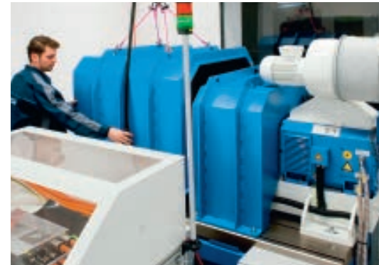
Herz des Labors ist der Elektromotorprüfstand. Schon bald werden hier für die Kunden Motoren genau unter die Lupe genommen.
