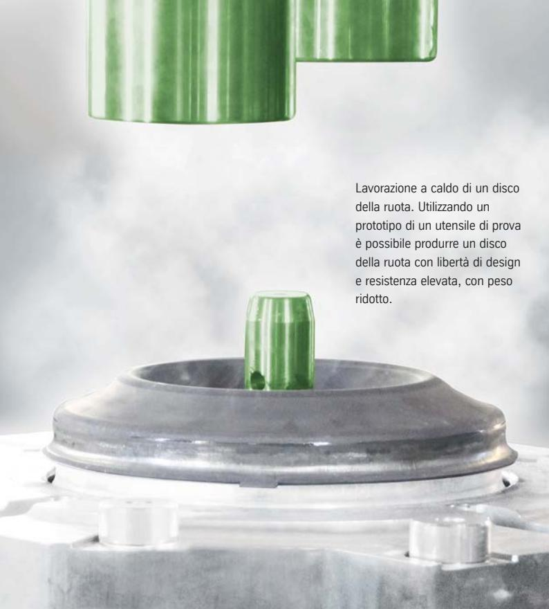
Lavorazione a caldo di un disco della ruota. Utilizzando un prototipo di un utensile di prova è possibile produrre un disco della ruota con libertà di design e resistenza elevata, con peso ridotto.
