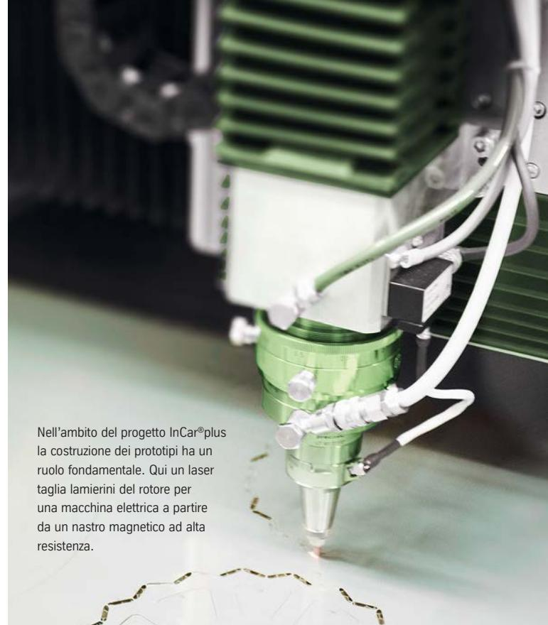
Nell'ambito del progetto InCar®plus la costruzione dei prototipi ha un ruolo fondamentale. Qui un laser taglia lamierini del rotore per una macchina elettrica a partire da un nastro magnetico ad alta resistenza.
