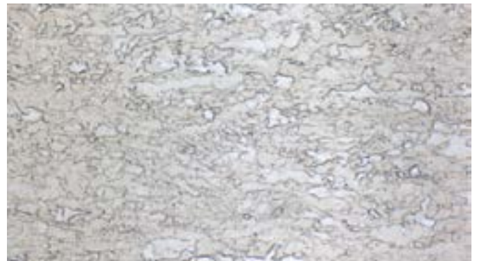
Mikrostruktur CH-W®. Gefügekontrastierung über Ätzung mit Nital.
