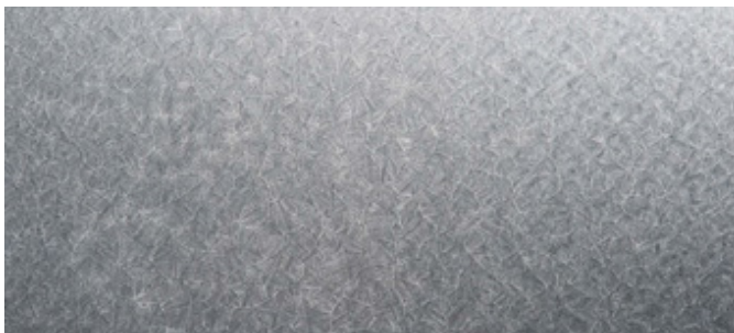
Beispiel einer nachgewalzten A-Oberfläche.
