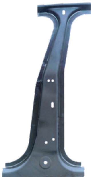
B-Säule aus presshärtablem Mangan-Bor-Stahl MBW®.
