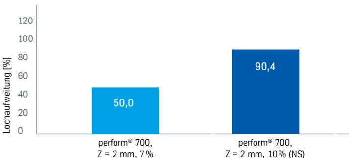
Lochaufweitung mit 50° Kegelstempel,  $D_0 = 20$  mm; links Referenz (7% Schneidspalt); rechts mit Nachschneiden ca. 80% der Blechdicke.
