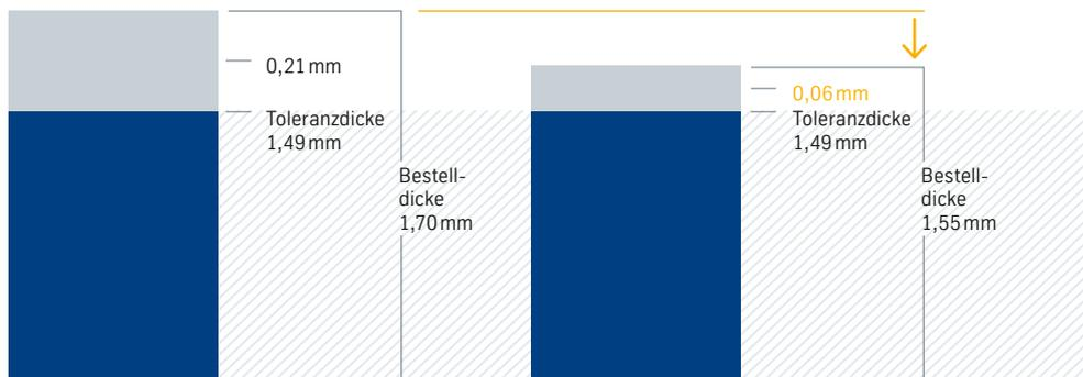
→ 8,8% weniger Gewicht aufgrund engster Dickentoleranzen bei scalur<sup>®</sup>+Z
